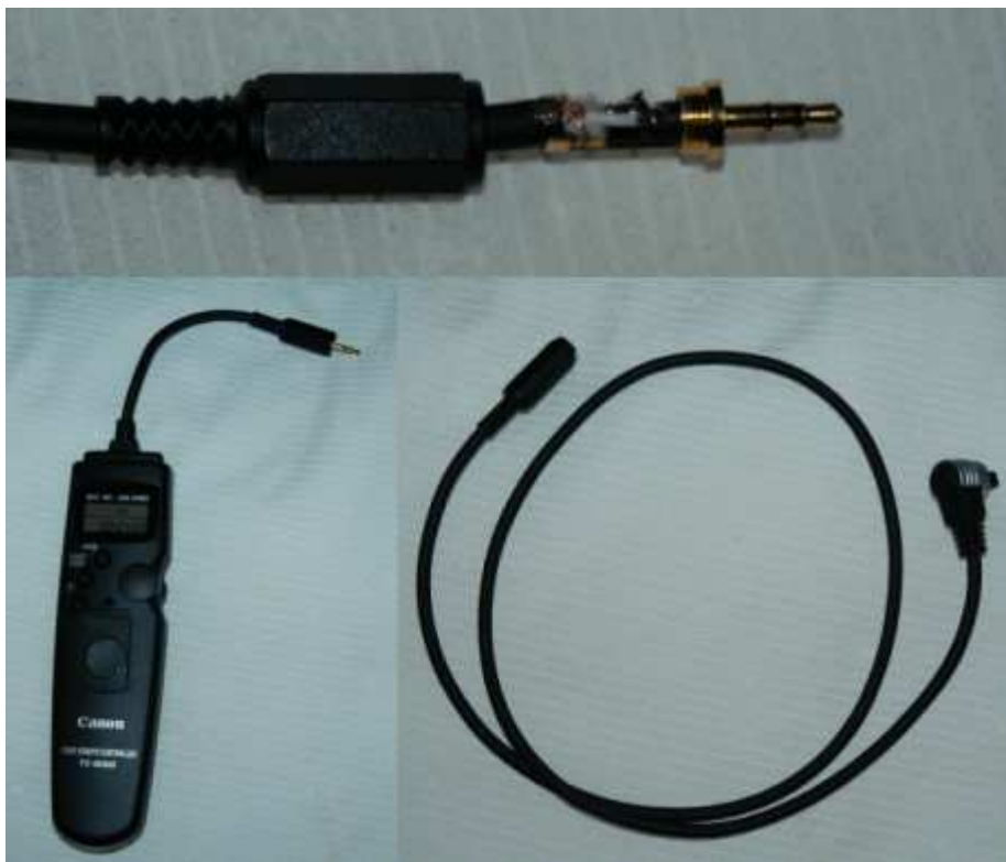
Connecteur détails (en haut) et les deux moitiés du câble ampoule modifié (en bas).
