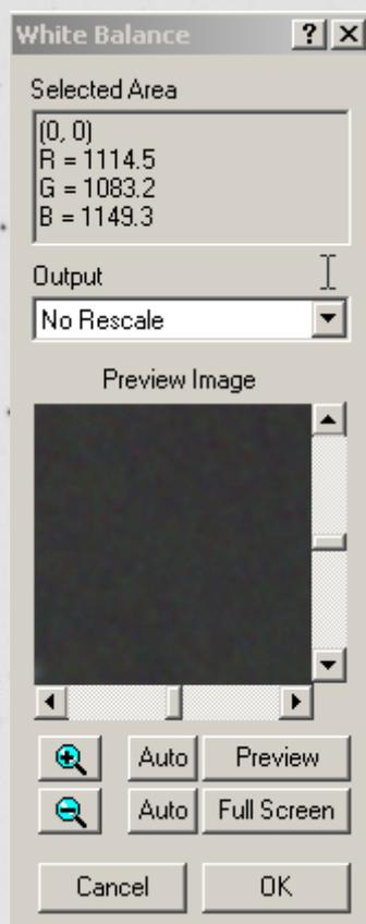
Il faut sélectionner une zone de fond homogène, paramétrer l'Output en No Rescale et valider par OK.
